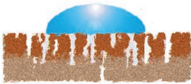
1. Reines Löschwasser „steht“ auf dem Brandgut
